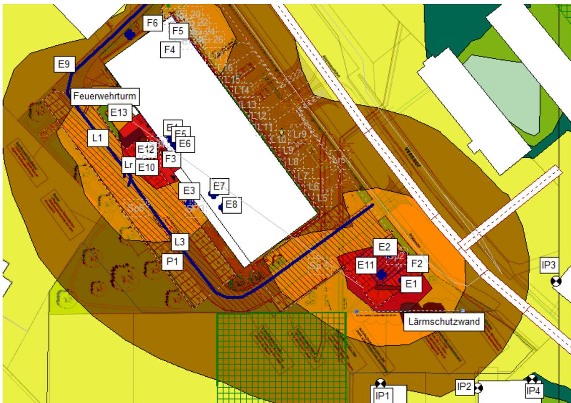
Abbildung 12 Geräuschimmissionen von allen Emittenten abgesehen von Einsätzen (ohne Schall-dämm wand)
